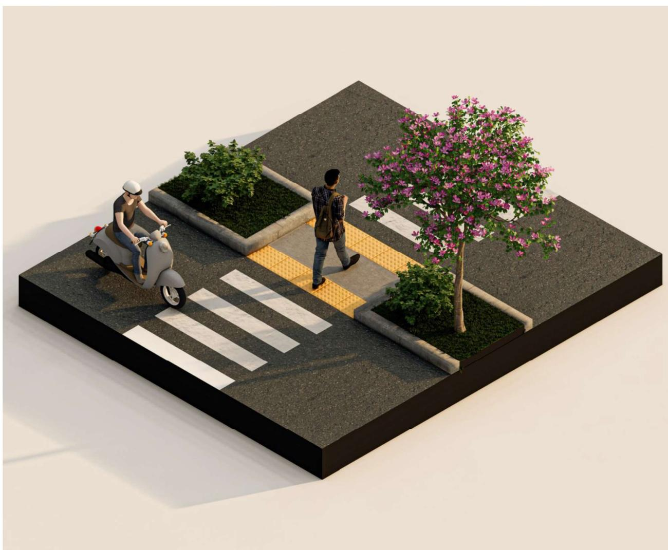
**Imagen.** Render isométrico donde se exhibe la volumetría del vado en bulevar, se aprecian solados de guía y prevención de color contrastante, materialidad, ubicación del cruce peatonal y demás señaléticas y/o detalles.
