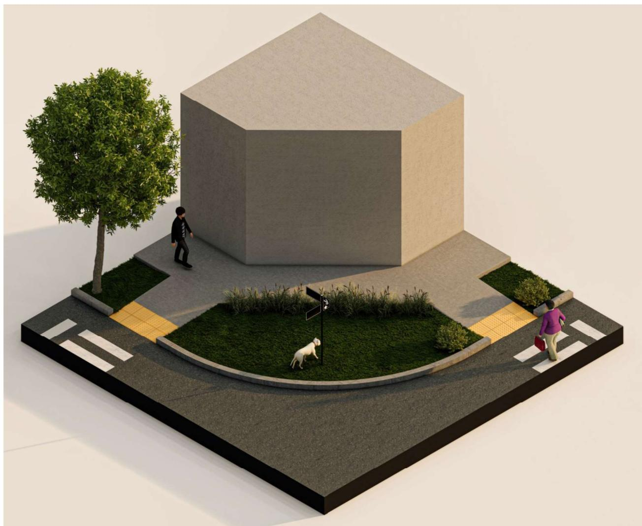
**Imagen.** Render isométrico donde se exhibe la volumetría del vado, las rampas que lo componen a fin de salvaguardar la altura de cordón, se aprecian solados de guía y prevención de color contrastante, materialidad, ubicación del cruce
