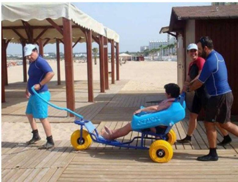
**Imagen** - Silla anfibia para personas con movilidad reducida. Dicha silla debe encontrarse en el final de las pasarelas y debe contar con personal para asistir al usuario, tal y como se ve en la imagen.
