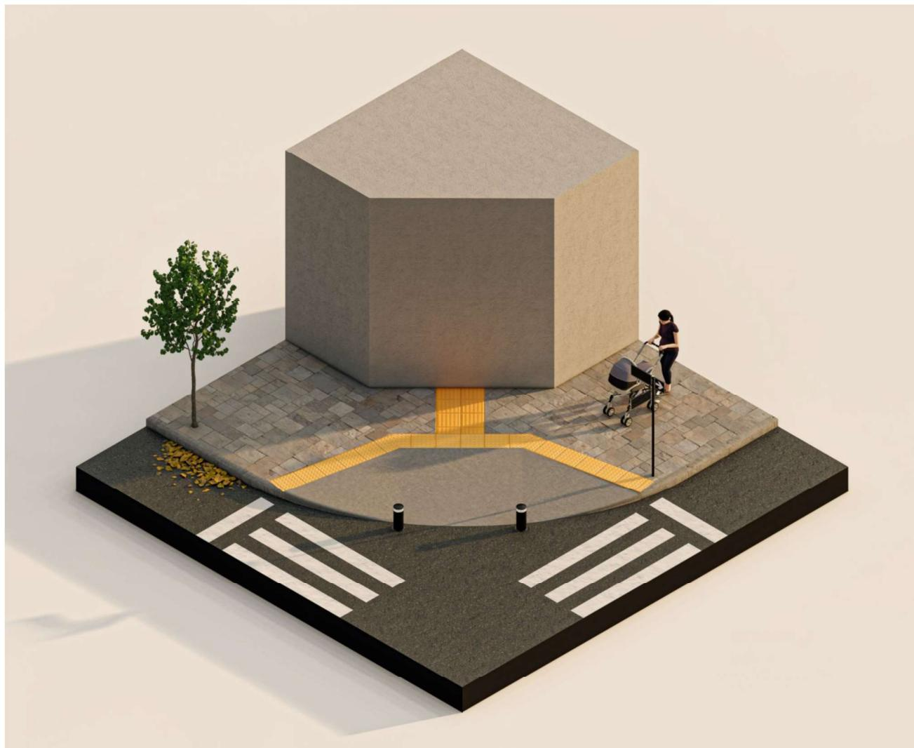
**Imagen.** Render isométrico donde se exhibe la volumetría del vado, las rampas que lo componen a fin de salvaguardar la altura de cordón, se aprecian solados de guía y prevención de color contrastante, materialidad, ubicación del cruce peatonal y demás señaléticas y/o detalles.
