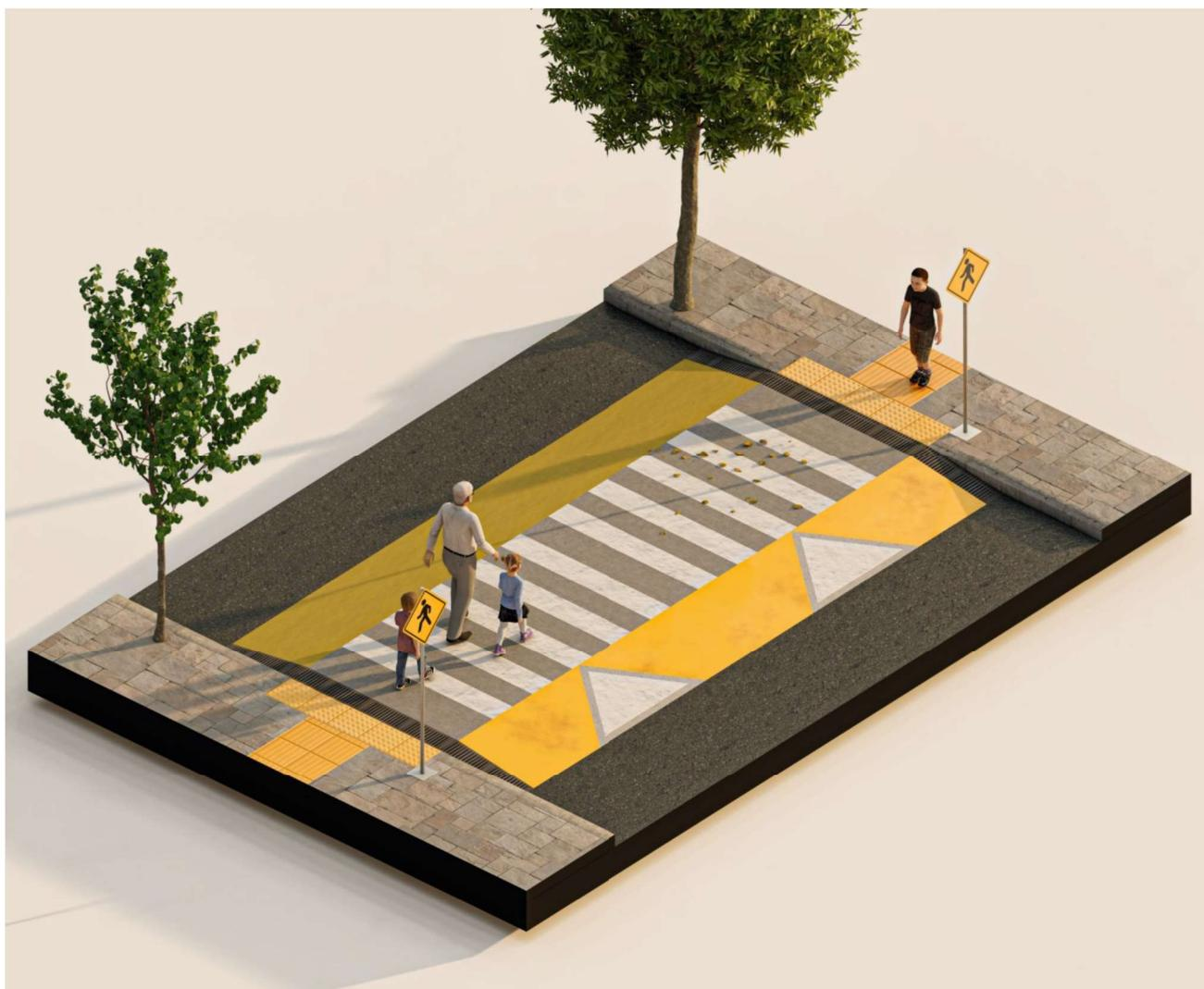
**Imagen.** Render isométrico donde se exhibe la volumetría de la elevación de senda, se aprecian solados de guía y prevención de color contrastante, materialidad, pasaje del desagüe lluvia, formato del cruce peatonal y demás señaléticas y/o detalles.
